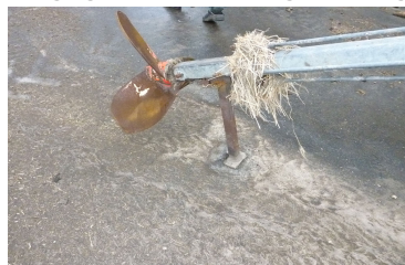
Støtteben trykker sig ned i asfalten
